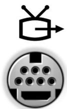
Consente di collegare il computer a un televisore. Connette anche periferiche S/PDIF tramite il cavo adattatore TV/audio digitale. Per ulteriori informazioni, vedere la sezione “Riproduzione di CD e filmati” nel file della guida *Istruzioni e procedure*. Per accedere al file della guida, vedere pagina 72.
